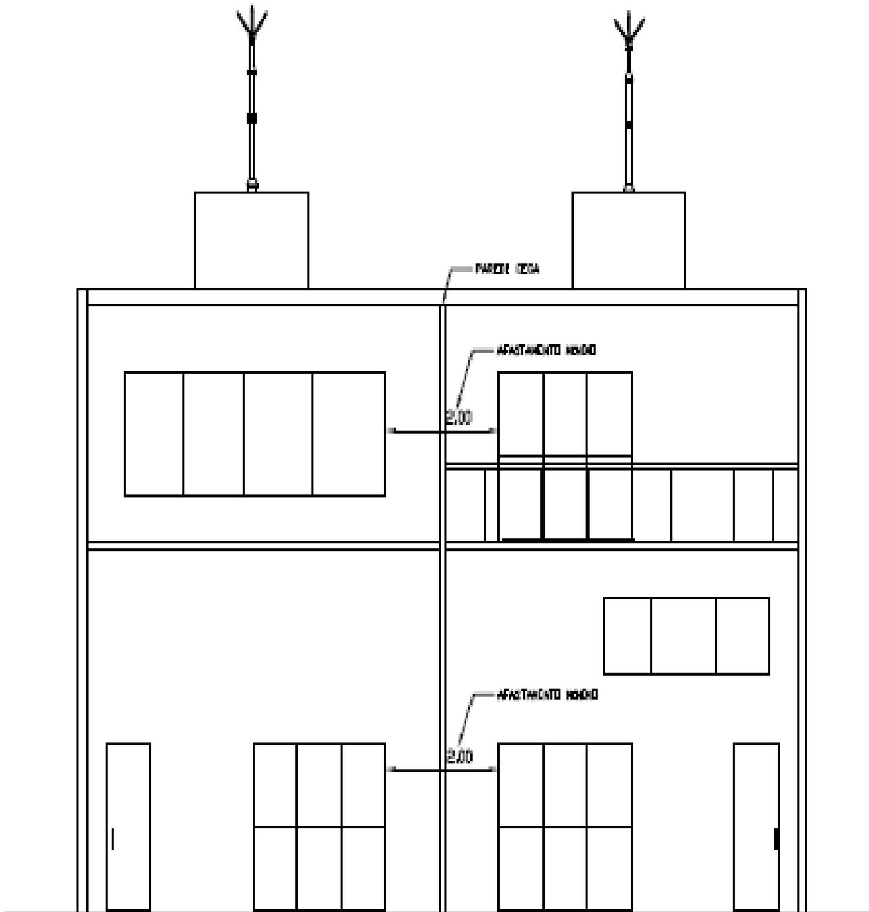
Figura 1 - Distanciamentos obrigatórios da parede cega
